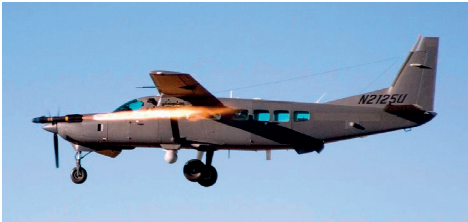
De AC 208, een aangepaste Cessna 208 Caravan met o. a. een ISR- en kinetische suit.
