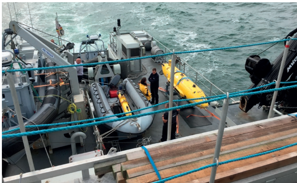
Figuur 5. Licht (70 kg) en zwaar (1000 kg) autonoom onderwatervaartuig op het achterdek van P902 Pollux tijdens MCM trials. (© BE Navy)
