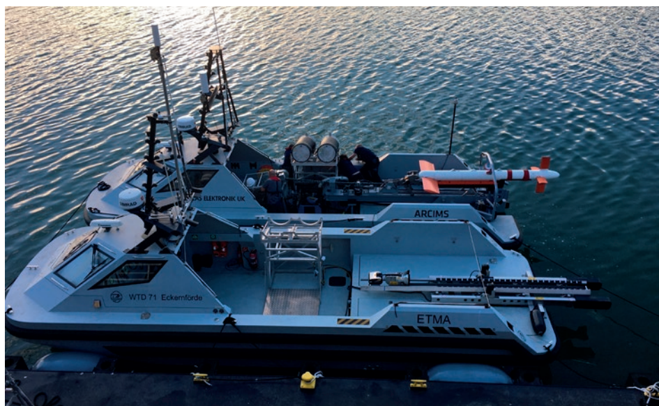
Figuur 2. Duitse en Engelse oppervlaktedrones met hun onderwatersensoren.
