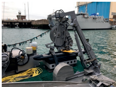
Figuur 3. Gesleepte SSS aan boord van een Israëlische oppervlaktedrone.
