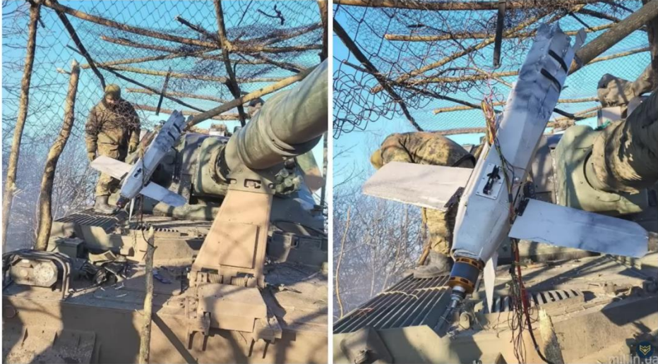
Afbeelding 3: AS90 overleeft een LANCET3-aanval dankzij een anti-UAS-net. 14
