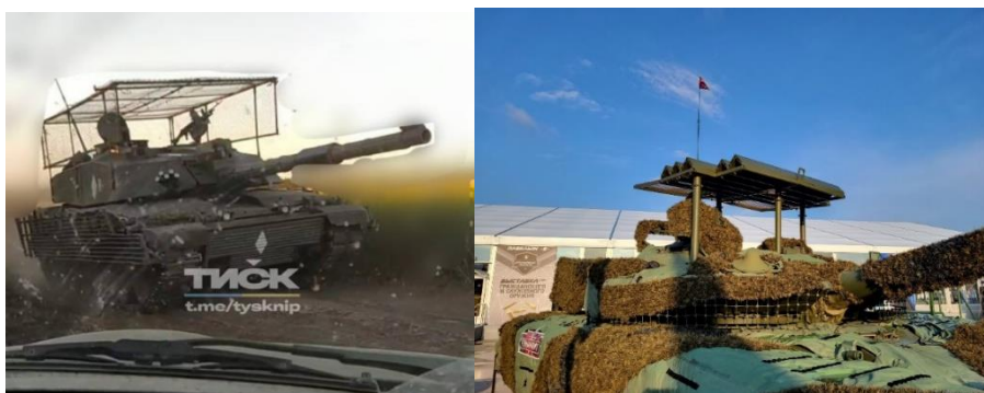
Afbeelding 2: afdak ter bescherming van de koepel tegen verticale dreigingen. 25
